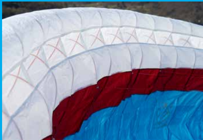
De milde sharknose wordt in vorm gehouden door staafjes.
