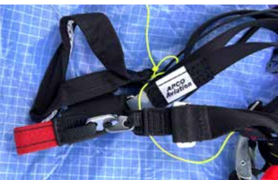
In ontgrendelde positie maakt dit systeem het mogelijk om het volledige snelheidsbereik met de trimmers te regelen.
