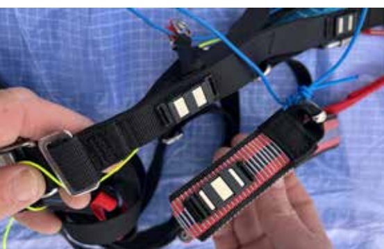
Comfortabele remtokkels met sterke magneten.
