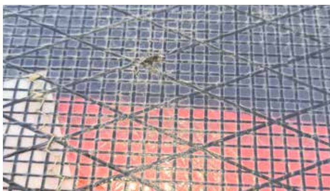
Voorbeeld van craquelé met gaatjes in Mylar, tip area. Foto: Martin van Helden
