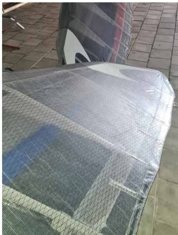
Seamkote-4 aangebracht op de buitenste vlakken van de tip area. Foto: Martin van Helden
