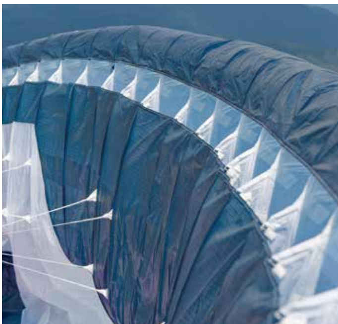
Onder: De A-lijnen hebben vier ophangpunten en zijn ver naar achteren geplaatst. Daardoor is het trekken van inklappers voor de certificering niet zomaar mogelijk en zijn 'folding lines' nodig.
