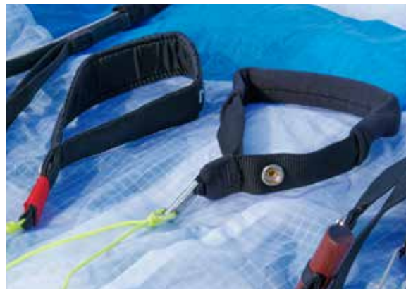
De remlus van de LiVi (links) heeft wat minder vulling dan die van de Vivo 2 (rechts) en geen swivel.
