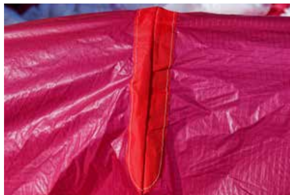
De neus van de LiVi met versterkingen om slijtage van de dunne stof over de nitinol staafjes te voorkomen.
