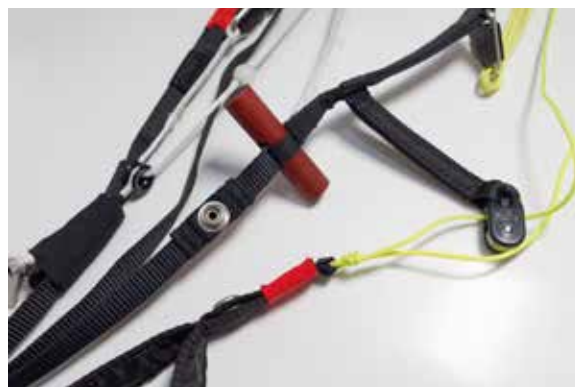
Het B/C-systeem om te sturen met de achterste risers met houten handvat en de verbinding tussen de C- en B-risers.
