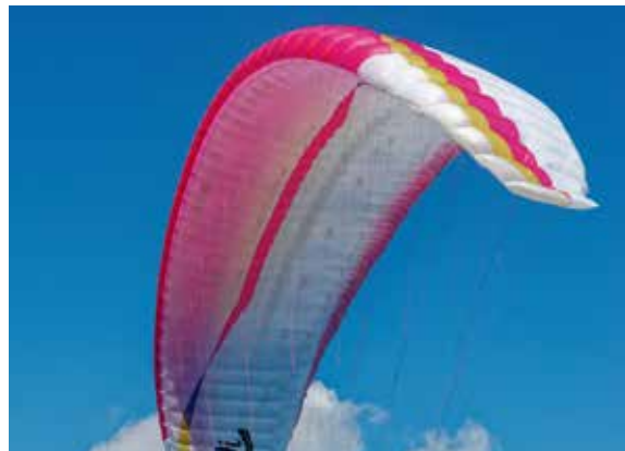
De stabilo's van zowel LiVi als Vivo 2 buigen enigszins naar boven net als een winglet. Airdesign claimt dat hiermee de geprojecteerde strekking iets hoger uitvalt, het scherm stabielere rechtuit vliegt en dat de weerstand lager is.
