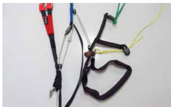
Remlus van de Vivo 2 met swivel en pulley voor de remlijn. De LiVi heeft geen swivel en een ring waardoor de remlijn loopt in plaats van deze pulley.
