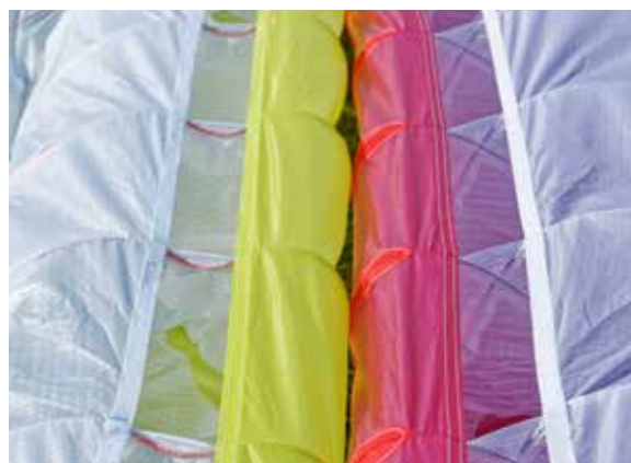
Gebogen plastic staafjes in de celopeningen van de Vivo 2 (links, geel) en de gekruiste nitinol staafjes in de cellen van de LiVi (rechts, roze).
