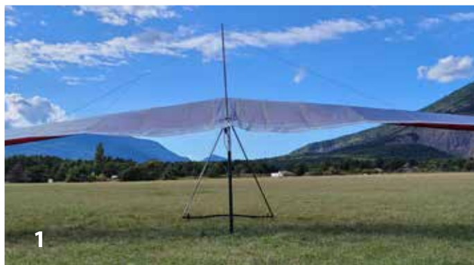
In foto 1 is de vleugel te zien zonder VG en in foto 2 met vol VG, bij vol VG zit er geen los doek meer rondom de kiel.
