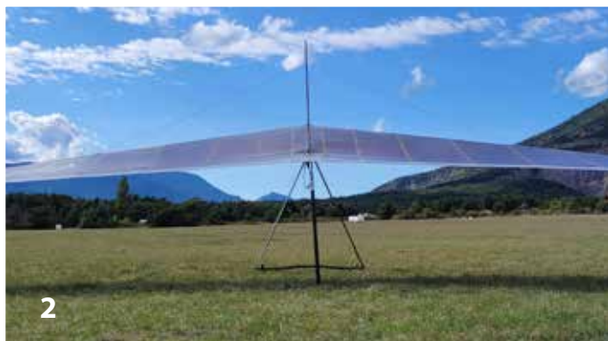
In foto 1 is de vleugel te zien zonder VG en in foto 2 met vol VG, bij vol VG zit er geen los doek meer rondom de kiel.
