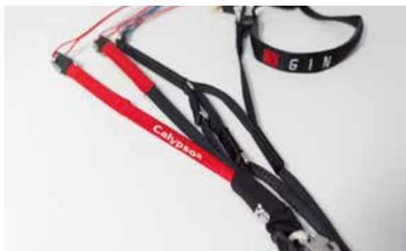
De risers van de Calypso 2 hebben kleur gecodeerde lussen, een zeer duidelijk gemarkeerde binnenste A-riser voor het opzetten.
