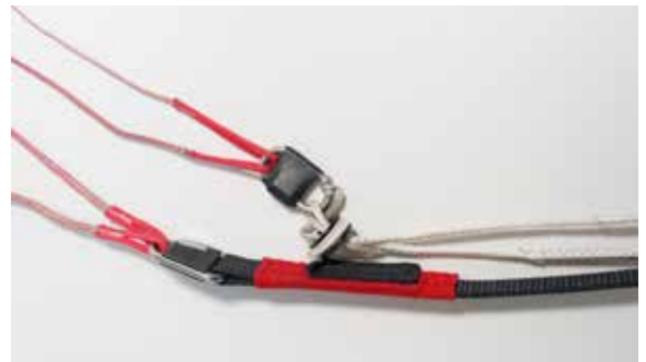
De A-riser heeft aparte buitenste A-lijnen met een zwevende constructie door een oogje.
