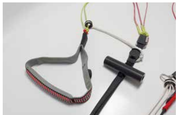
De achterste (B) risers met staafje voor sturen met de B's en standaard Gin remlussen met magneet. Wij geven eerlijk gezegd de voorkeur aan de zachte lussen van de Calypso 2.
