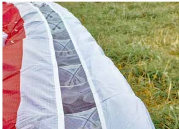
De leading edge heeft nitinol staafjes ter versteviging en een 'half-rib Rigifoil' met staafjes en een koordje halverwege de cellen.
