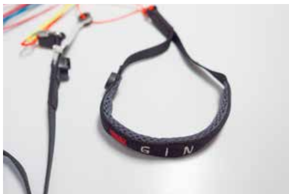
De lichtgewicht remlussen zijn zeer comfortabel en hebben een sterke magneet voor het vastzetten van de lus.
