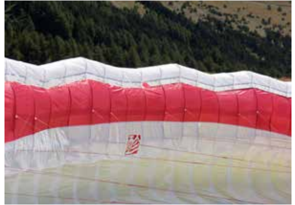
De Camino 2 heeft de typische Gin Wave Leading Edge, versterkt met staafjes en een koordje in de celopeningen.
