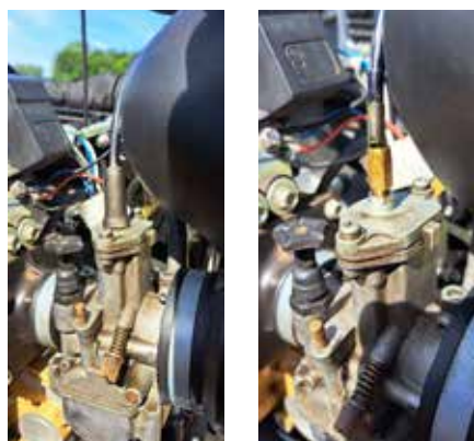
De buitenmantel van de gaskabel kan op de buitenbus blijven hangen in plaats van erin vallen.
