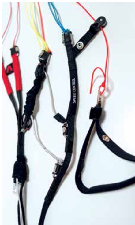
De risers zijn rechttoe rechtaan en de lijnen duidelijk gekleurd. Geen lus voor C-sturen, gewoon de riser vastpakken.
