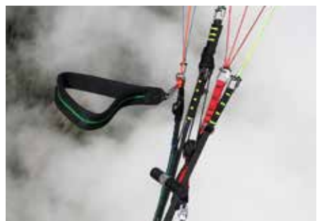
De A-riser is felrood, de B3-riser voor het trekken van B3-oren zie je rechts daarnaast met één geel lijntje eraan. De zachte neopreen remlussen hebben een snaplock magneet.
