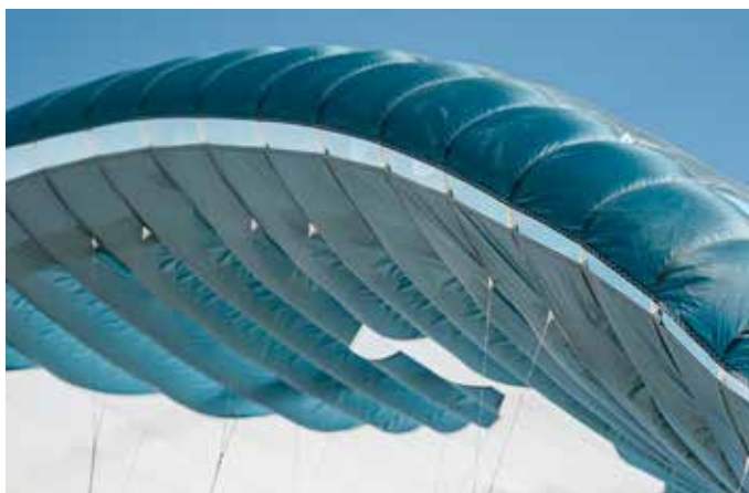
De celopeningen zijn versterkt met halfronde staafjes.
