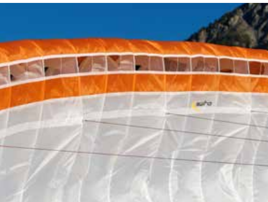
Typisch voor Swing is het ontbreken van een sharknose. De draden voor de celopeningen beperken het opbollen van de leading edge.
