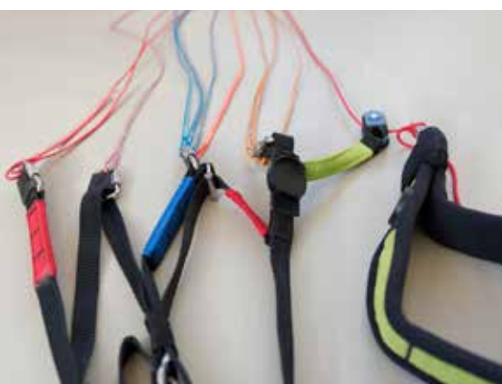
De NyoS 2 RS heeft een zogenaamde C-bridge. Hiermee kan de invalshoek van elke kant gecontroleerd worden, met name tijdens versneld vliegen.
